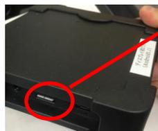
プッシュするとmicroSDカードが出てきます。挿入時は「カチッ」と音がするまで差し込みます。
