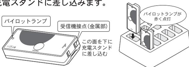
受信機上部のパイロットランプが赤く点灯し、充電が開始されます。
