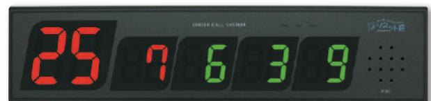
型式：片面タイプ SRE-K-P / SRE-K-LP・両面タイプ SRE-R-P / SRE-R-LP、サイズ：W465×H112×D42 (SRE-K-P)・×D49 (SRE-R-P) (突起部を除く)、重量：925g (SRE-K-P)・1170g (SRE-R-P)、電源・電圧：AC100V(15VA)、受信周波数：426MHz帯（特定小電力型）、消費電力：10W/2A(SRE-K-P)・15W/3A(SRE-R-P)、表示方法：5桁 2 枝 / 赤色 LED の場合着信順に左から表示、緑 LED の場合右から 3 枝、表示消去：消し機による消去 / タイマー自動消去、チャイム：14 種類の音色 / 設定変更可能、音量調整：6 段階、スピーカー出力：2W、使用温度：0°C～40°C
